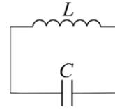
$U_L + U_C = 0$ . ЭДС на катушке в любой момент равно по модулю и противоположно по направлению ЭДС самоиндукции (т.к. сопротивление катушки равно нулю), поэтому  $U_L = -\varepsilon = L \frac{dI}{dt}$ . Сводя все воедино, получим уравнение:
