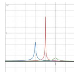
На графике справа показаны графики амплитуды от частоты для разных резонансных частот и разных добротностей (чем выше график, тем больше добротность).
